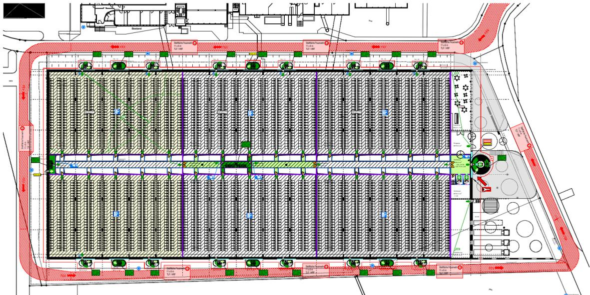
Abbildung 25 Anordnung der vertikalen Fluchtwege
